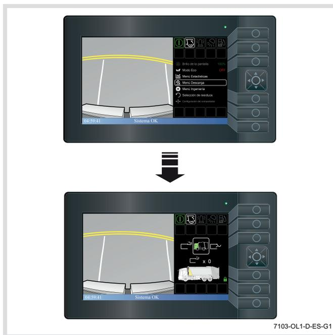
7. Utilice las flechas izquierda y derecha del cursor para resaltar los controles de descarga de la cabina. Los "Controles en la-cabina" se seleccionan cuando la carrocería se muestra en verde.
