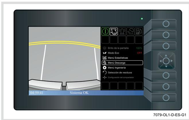
2. Desplácese con las flechas izquierda y derecha del cursor para resaltar las opciones de los mandos de descarga de la cabina o los mandos externos de la caja. La opción de mandos de descarga de la cabina está seleccionada cuando la cabina se muestra en verde. Para seleccionar entre los mandos de descarga de la cabina y la opción de control externo de la caja, pulse el botón central del cursor.
