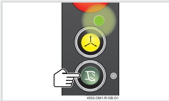
Conforme el mecanismo de compactación realiza su ciclo, los pictogramas correspondientes se mostrarán en la pantalla del panel de control a medida que se produce cada etapa del ciclo: apertura de la pala compactadora, desplazamiento descendente del trineo, cierre de la pala compactadora, desplazamiento ascendente del trineo.
