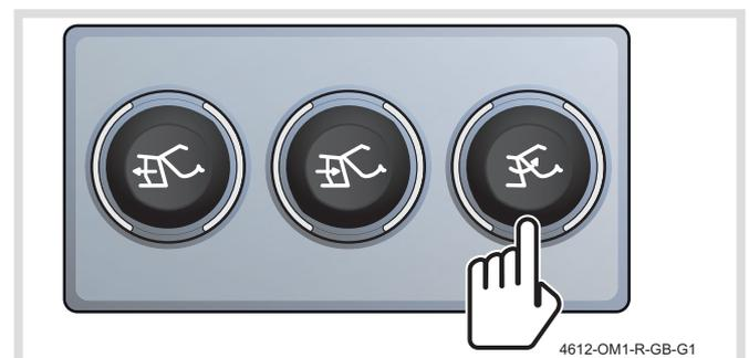
Oprima y mantenga presionado el pulsador "Elevación de la compuerta trasera" en el panel de control de descarga externo para elevarla.
