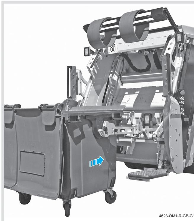
5. Accione el pulsador "Elevación del dispositivo" para subir el dispositivo de elevación hasta que los muñones situados en el lateral del contenedor de residuos encajen en los ganchos de los brazos.
