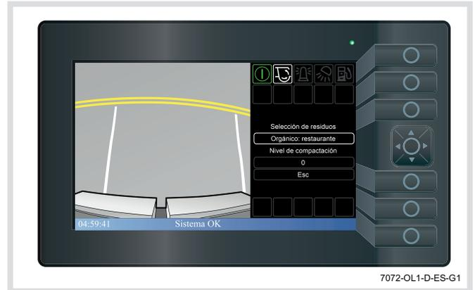
3. Desplácese con las flechas izquierda y derecha del cursor para seleccionar el tipo de residuo deseado. Existen 10 selecciones de residuos diferentes, véase la tabla siguiente:
