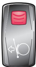
El interruptor de 'Anulación del bloqueo del freno automático/compuerta trasera desbloqueada' permite al conductor anular el 'Bloqueo del freno automático/compuerta trasera' en caso de emergencia (consulte '5.5 Bloqueo del freno automático/compuerta trasera desbloqueada (opcional)' en la página 5-22).
