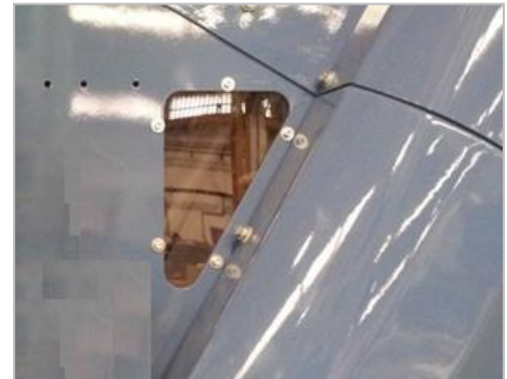
Ventana de inspección del tailgate
