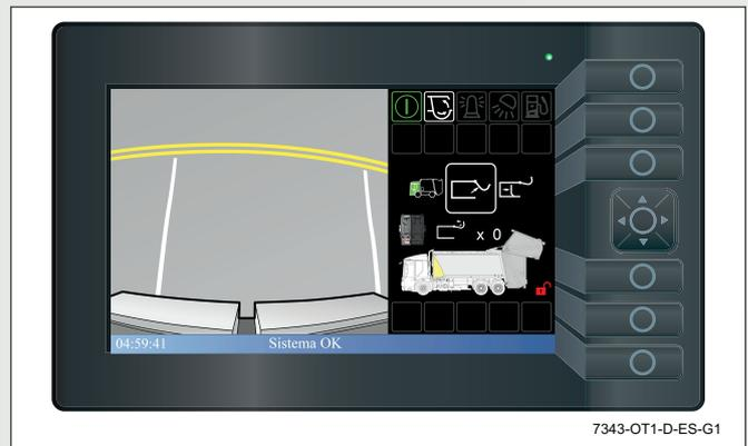
Para elevar la compuerta trasera derecha, utilice las flechas izquierda y derecha del cursor hasta que se resalte el segundo icono 'Elevar compuerta trasera' y se resalte la compuerta trasera derecha en la pantalla.
