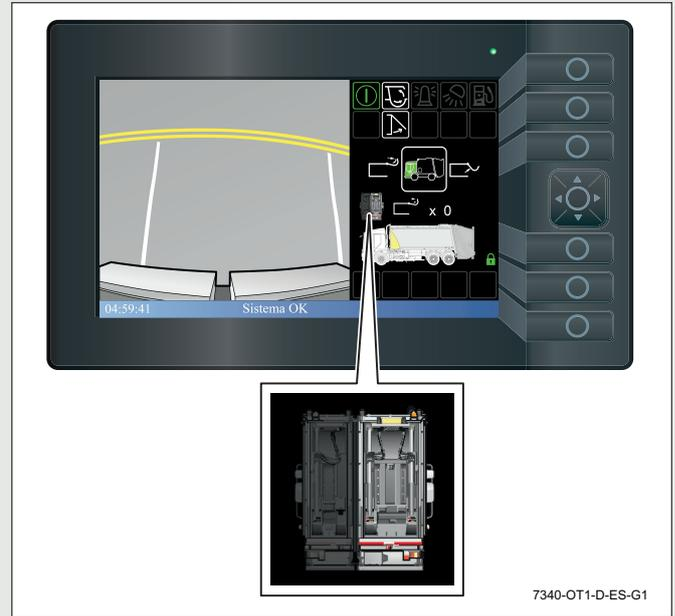
23. Compruebe que se ha seleccionado el lado correcto de la carrocería mediante el interruptor o la opción del menú, que se mostrará en la pantalla y asegúrese de que no aparecen mensajes de error.
