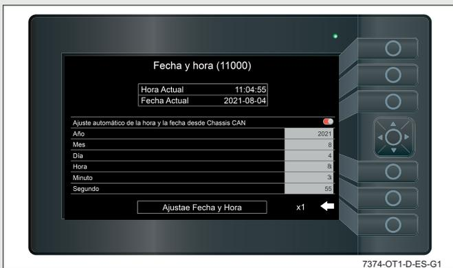
10. Para volver a la pantalla del 'Menú principal', utilice las flechas del cursor para resaltar la flecha situada en la parte inferior derecha de la pantalla.
