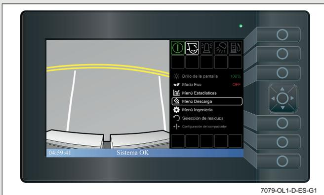
10. Utilice las flechas izquierda y derecha del cursor para resaltar los controles 'en la cabina'. La opción de controles en cabina se selecciona cuando la cabina se muestra en verde.
