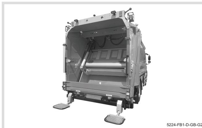
Los estribos y los pasamanos permiten a los operarios ir en la parte trasera del vehículo cuando recogen la basura, cuando la legislación permite el uso de estribos.
