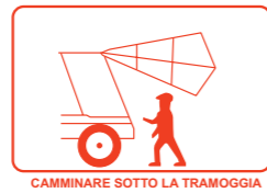
CAMMINARE SOTTO LA TRAMOGGIA SOL LEVATA
