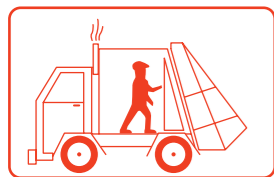
ENTRER DANS LE CAISSON LORSQUE LE MOTEUR EST EN MARCHÉ
