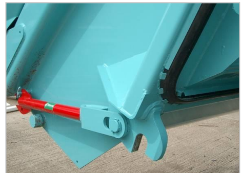
Ancrage pour fermeture de la porte arrière
