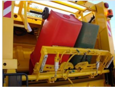
Lève-conteneurs polyvalent en position haute
