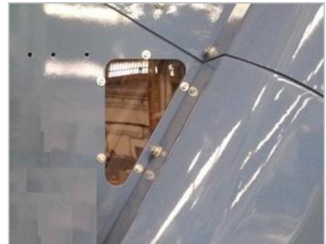
Fenêtre d'inspection de la porte arrière
