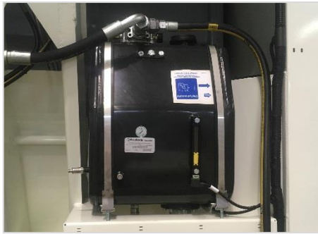
Réservoir d'huile sur la partie avant du caisson
