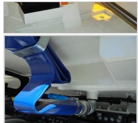
Vue intérieure du réservoir et vue extérieure du tuyau de vidange
