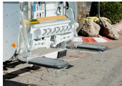
Marchepieds avec détection de poids
