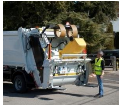
Lève-conteneurs polyvalent en position haute
