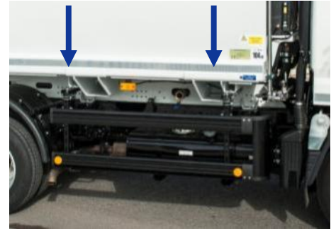
Pare-cyclistes installés sur les rails
