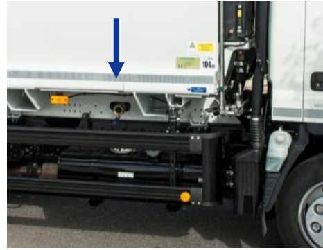
Vue extérieure du tuyau de vidange
