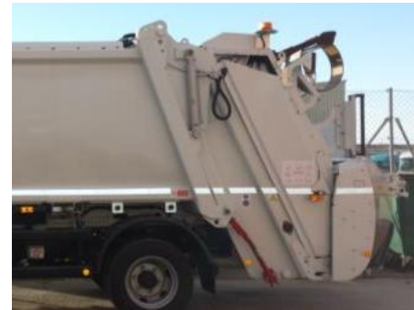
Trappe de déchargement découpée
