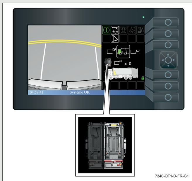
23. Vérifiez que le bon côté de la benne est sélectionné avec l'interrupteur ou l'option du menu. Vérifiez l'affichage de l'écran et assurez-vous qu'aucun message d'erreur n'apparaît.
