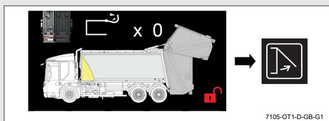
12. Appuyez sur le bouton-poussoir de levage du hayon situé sur le boîtier extérieur de commandes de déchargement et maintenez celui-ci jusqu'à ce que le hayon soit entièrement relevé; relâchez alors le bouton.
