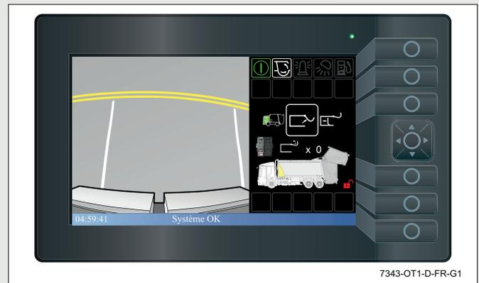
Pour relever le hayon droit, utilisez les flèches gauche et droite sur le curseur jusqu'à ce que la deuxième icône « Relever le hayon » soit mise en surbrillance et que le hayon droit soit mis en surbrillance sur l'écran.
