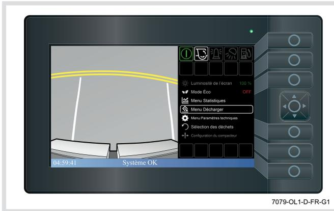
2. Utiliser les flèches gauche et droite du curseur pour mettre en évidence les commandes de la cabine. Le choix des commandes internes de déchargement est sélectionné quand la cabine s'affiche en vert.
