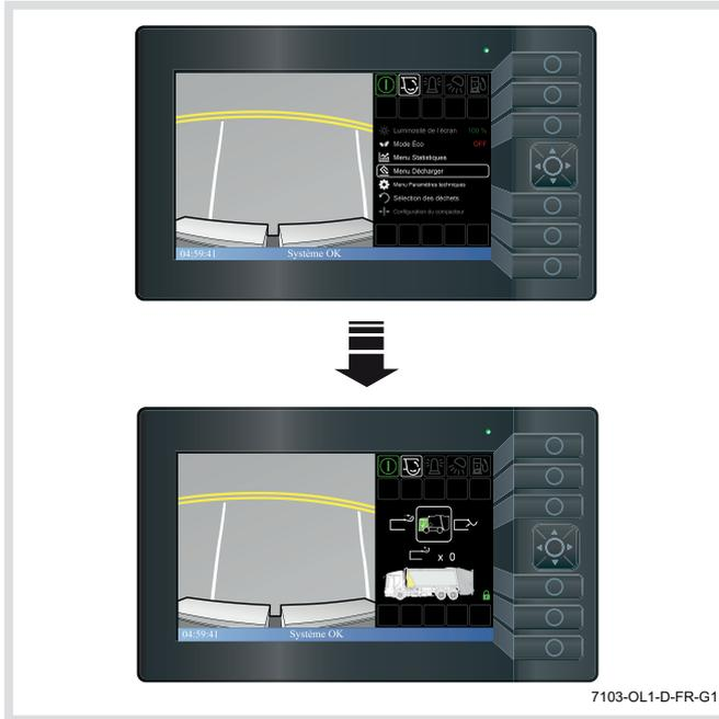
7. Utiliser les flèches à gauche et à droite du curseur pour afficher les de commande externes de la benne placées dans la cabine. Le choix des commandes internes de déchargement est sélectionné quand la cabine s'affiche en vert.
