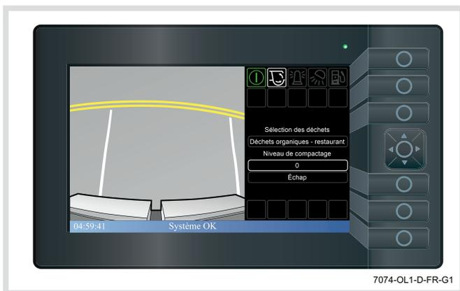
3. Utiliser le curseur à gauche et à droite pour sélectionner le niveau de compactage requis de 0 à 9.
