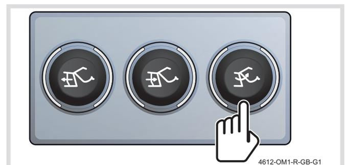
Appuyez sur le bouton de levage du hayon et tenez-le appuyé sur le panneau de commande de la décharge extérieure pour relever le hayon.
