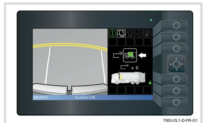
3. Pour retourner au menu principal, utiliser les flèches vers la gauche et la droite du curseur pour faire apparaître la flèche de retour et appuyer sur le bouton au milieu du curseur pour retourner au menu principal.
