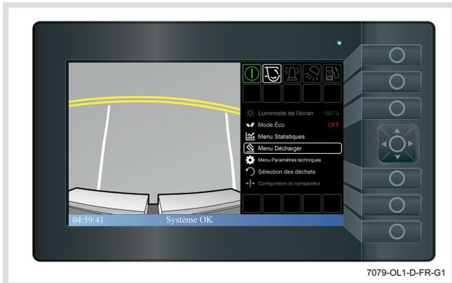
2. Utiliser les flèches à gauche et à droite du curseur pour afficher les options de commande externes de la benne placées dans la cabine. Le choix des commandes internes de déchargement est sélectionné quand la cabine s'affiche en vert. Pour sélectionner la commande interne ou externe de la benne, appuyer sur le bouton du milieu du curseur.
