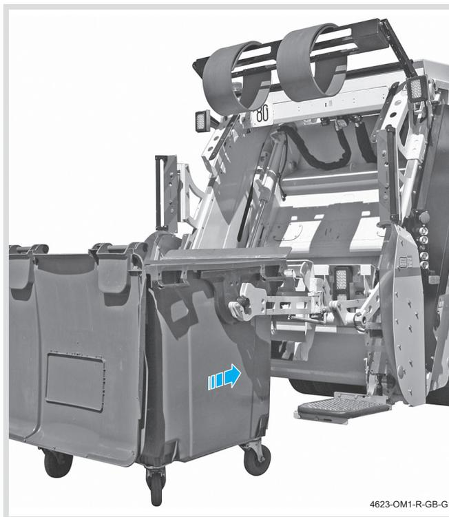
5. Actionnez le bouton de dispositif de levage vers le haut pour relever ce dispositif jusqu'à ce que les tourillons entraînent les crochets des bras.
