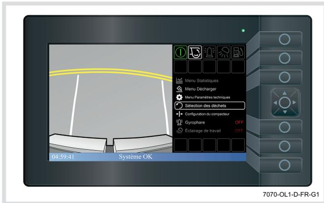
4. Lorsque vous aurez sélectionné le niveau de compactage requis, utiliser la flèche vers le haut et le bas du curseur pour faire apparaître « Echap » et appuyer sur le bouton au milieu du curseur pour revenir à l'écran principal. Si aucun bouton n'est appuyé pendant 20 secondes, l'écran retournera automatiquement à l'écran principal.
