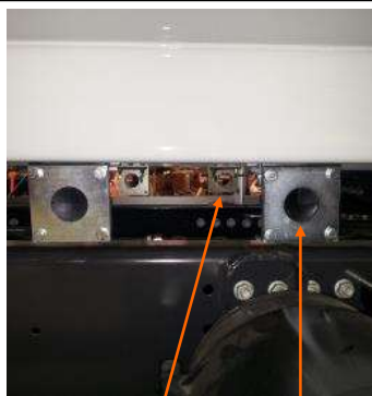
Soporte pala y escoba Soporte pala y escoba con relleno de goma
