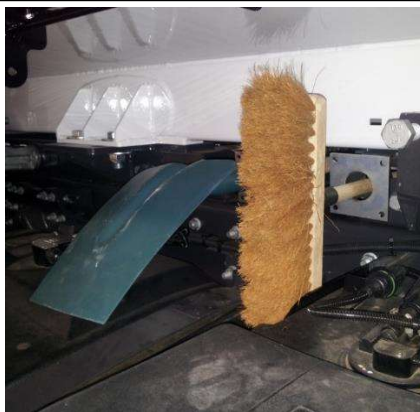
Soporte pala y escoba Soporte pala y escoba con relleno de goma
