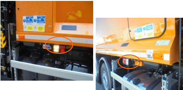
Luces indicadoras de grúa en ambos casos del colector.
