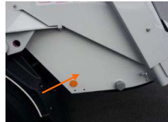
Vista detallada de la pintura especial y el material fonoabsorbente.
