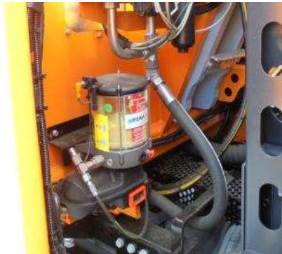
Con bomba automática
